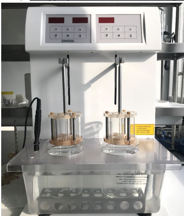
Figura 6. Disaggregatore (Erweka ZT 320) utilizzato per eseguire il saggio di disaggregazione nel presente lavoro di Tesi.
