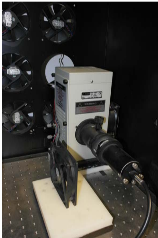
Figura 4.5: Simulatore solare e box di contenimento.
