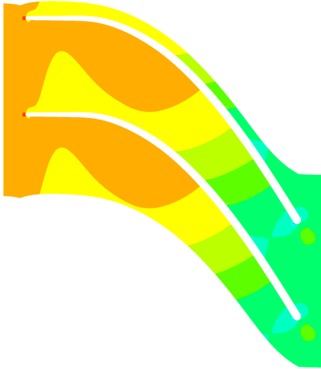
Figura 62: Andamento della pressione sullo span 0,5.
