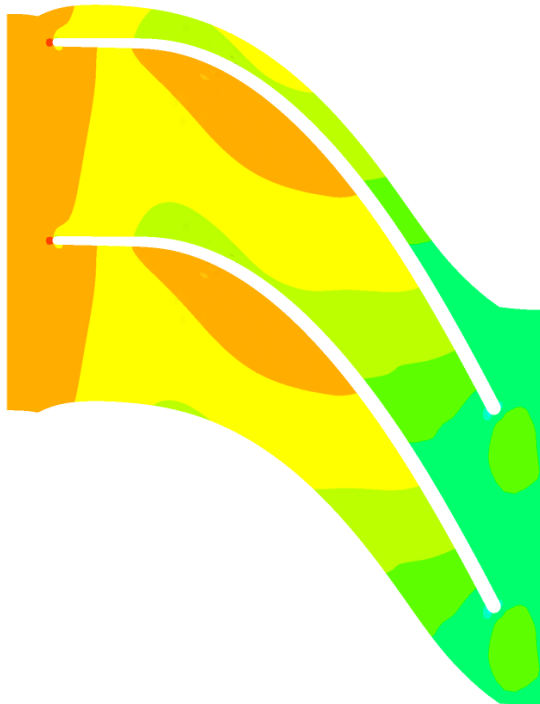
Figura 62: Andamento della pressione sullo span 0,5.
