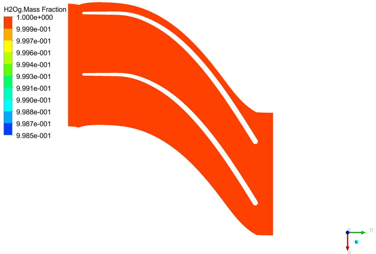
Figura 70: Frazione di massa del vapore allo 0,5 span.
