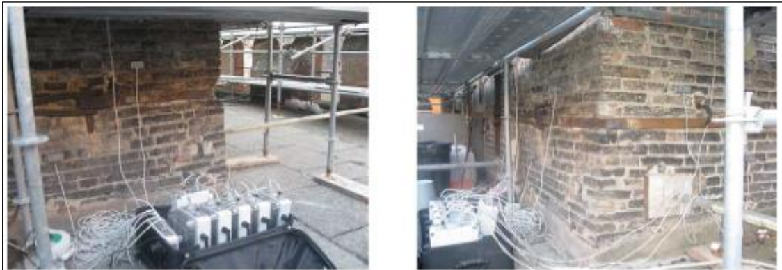
Figura 8: Foto del sistema di acquisizione dati ad emissione acustica alla base delle torri (Carpinteri et al. , 2011).
