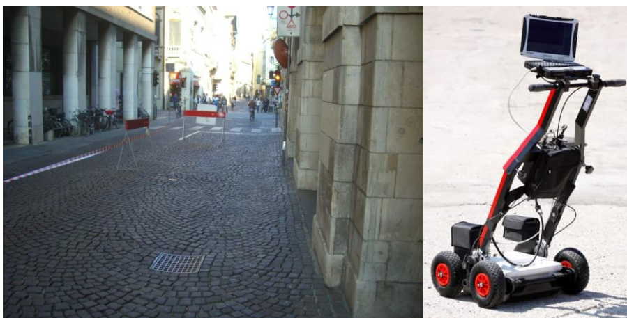
Figura 108: Chiusura traffico in via S. Francesco e lo strumento utilizzato per le indagini sulla pavimentazione.
