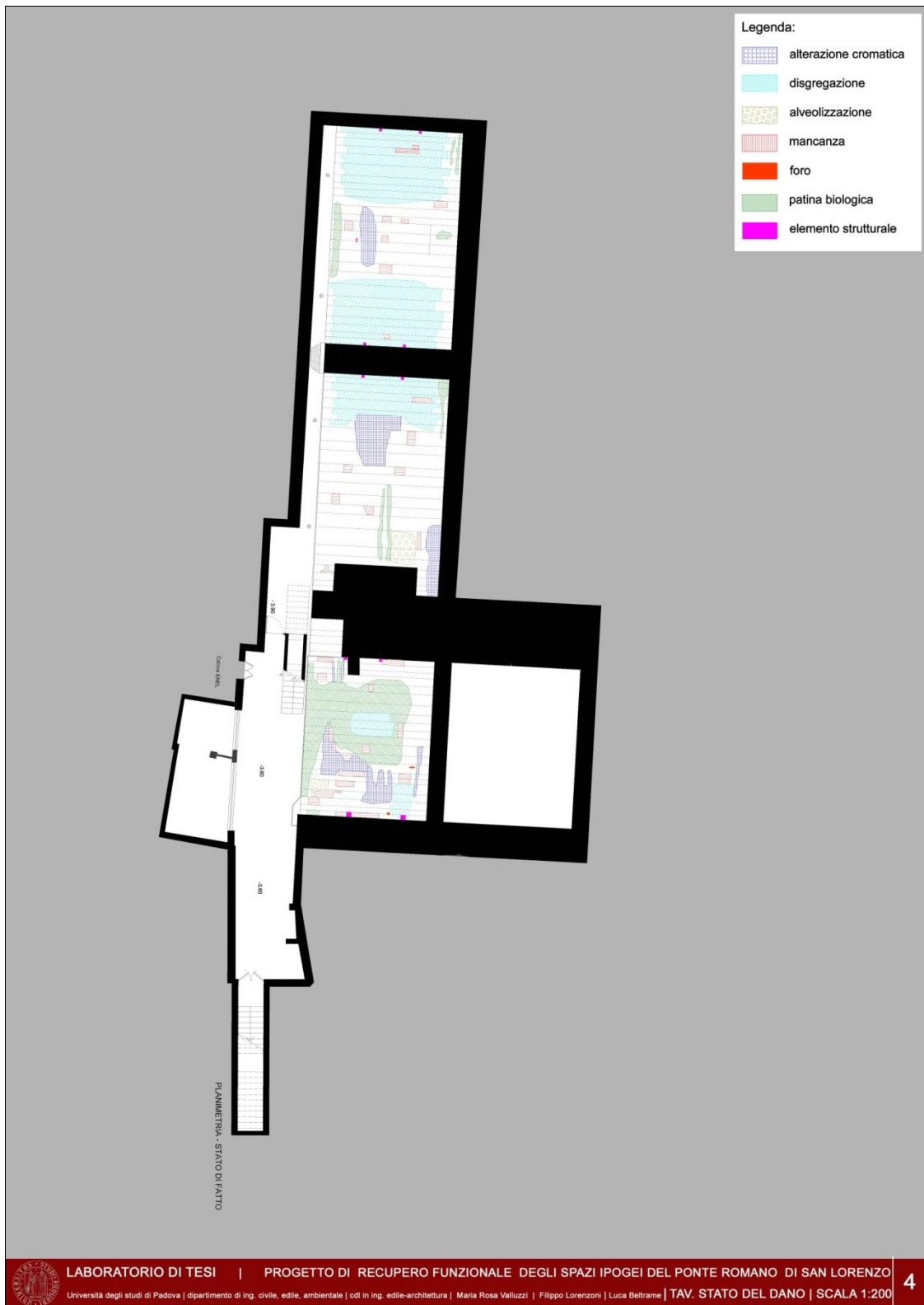
Appendice C 1: Rilievo dello stato del danno del ponte San Lorenzo.
