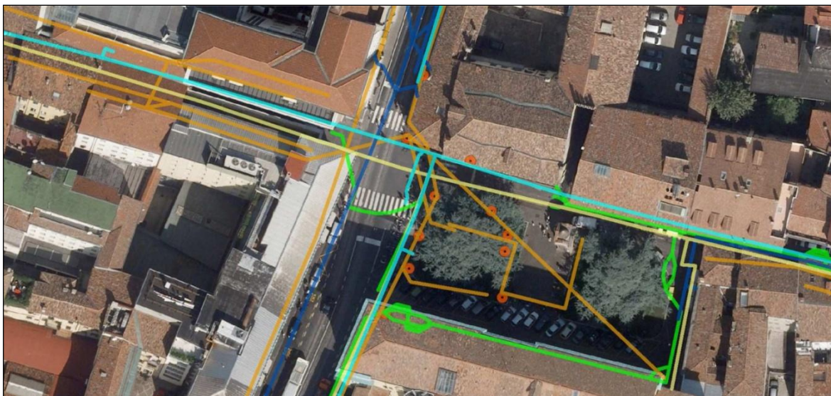
Figura 105: La situazione del sottosuolo per quanto riguarda le tubature. Legenda: giallo, gas; verde, telecomunicazioni; blu, fognatura; celeste, acquedotto; arancio, elettricità. (AcegasAps).
