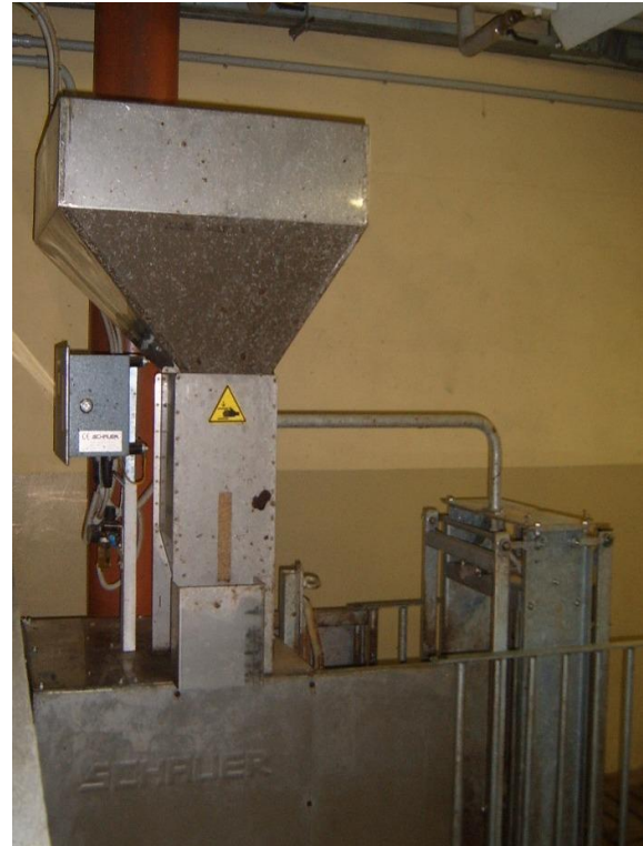
Figura 4. Stazione di autoalimentazione
