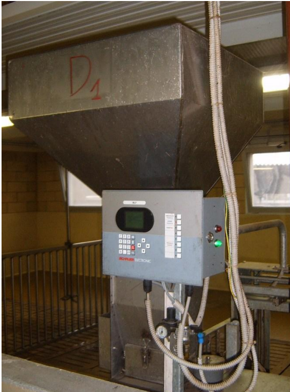
Figura 3. Stazione di autoalimentazione, pannello di controllo
