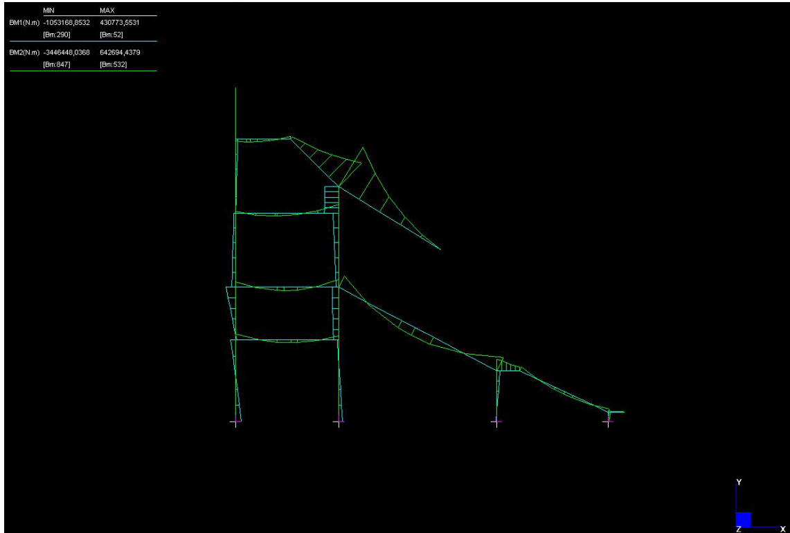
Figura 6.5. Grafico del momento per combinazione statica Tribuna Est, telaio tipo
