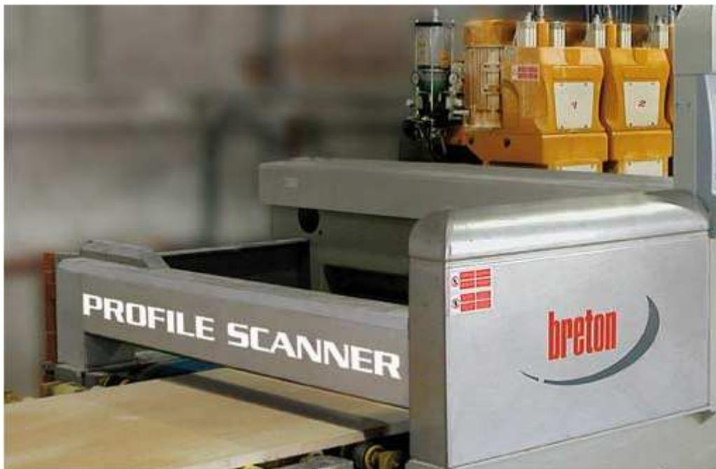
Fig 3-10 Scanner di rilevazione profilo lastra
