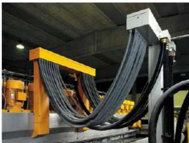
Fig 3-14 Collegamento elettrico trave mobile
