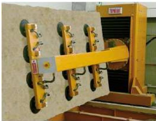
Fig 3-21 Caricatore/scaricatore automatico
