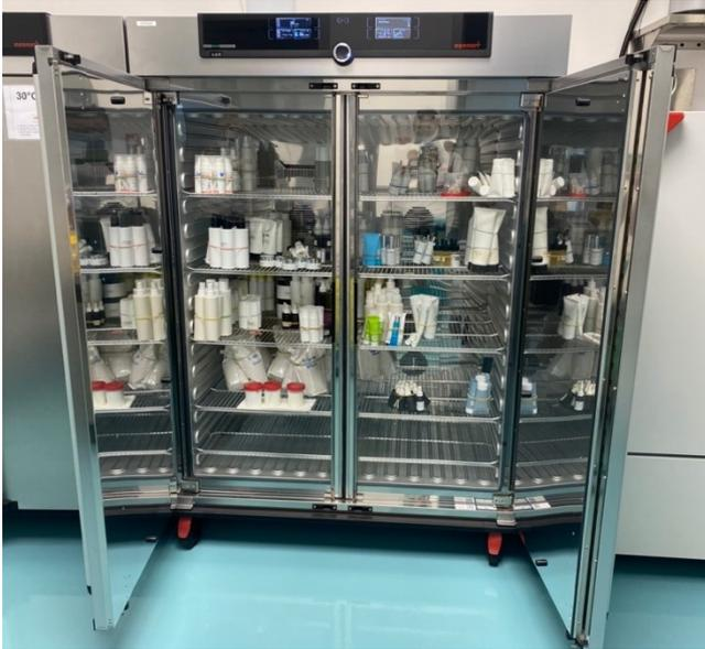
**Figura 34** Camera climatica per studi di stabilità
