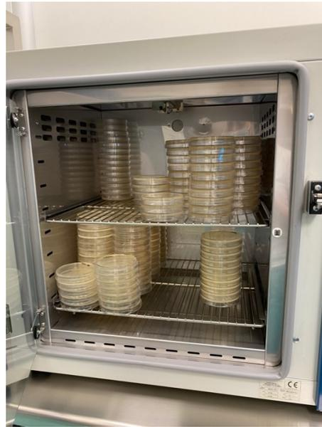
*Figura 36 Incubatore a  $32,5^{\circ}\text{C} \pm 2,5^{\circ}\text{C}$  con piastre*
