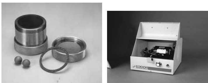
Fig. 3.1 Rappresentazione a sinistra di uno shaker mill con, a destra, il corrispondente sistema di sfere e giara
