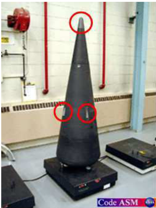
Fig.2.15 Modello di rientro SHARP-B2 pronto per il test. I cerchi rossi indicano i nuovi componenti UHTC a base di \text{ZrB}_2 .
