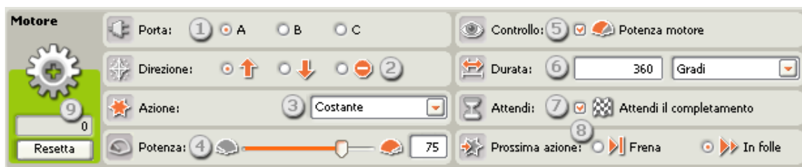
Figura 2.2: Le caratteristiche del blocco Motore
