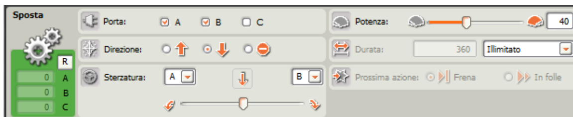
Figura 3.11: Le impostazioni del primo blocco Sposta
