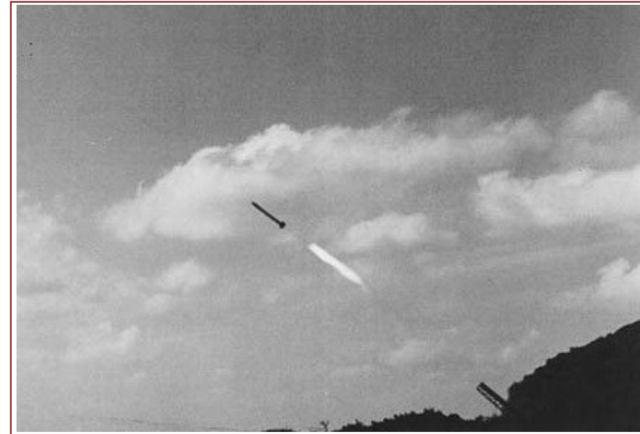
scia di fumo prodotta dai gas di scarico di un comune propellente nitropolimerico
