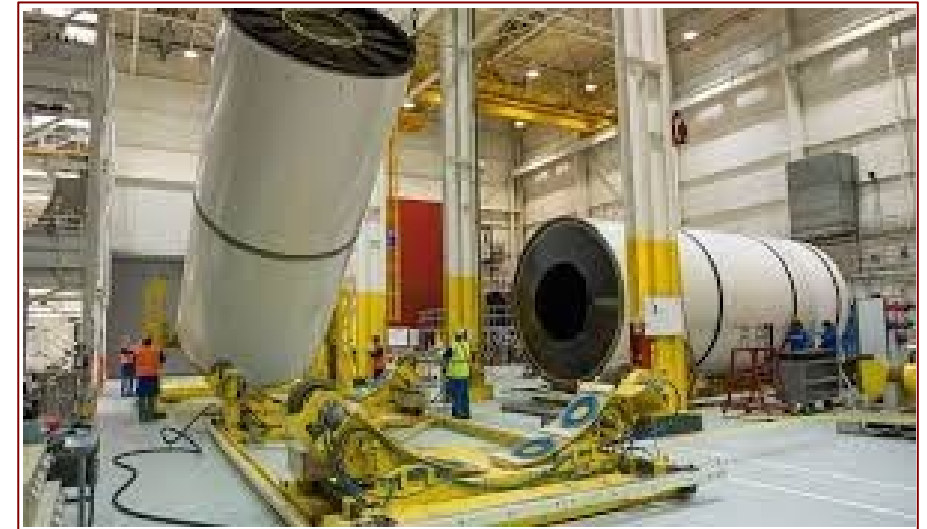
grani di propellente all'interno di sezioni di SRB (Solid Rocket Booster)
