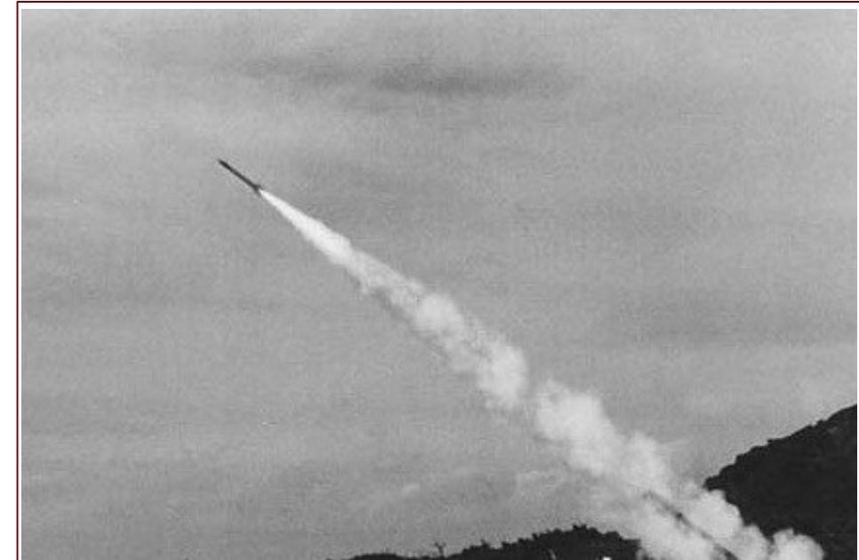
scia di fumo prodotta dai gas di scarico di un comune propellente composito di tipo AP
