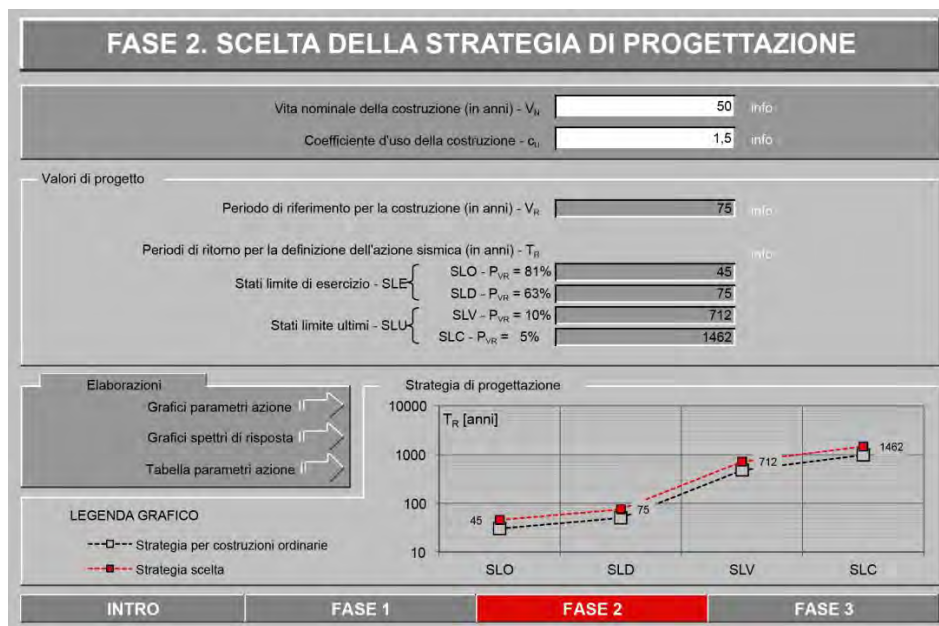
Figura 5.2 Fase 2 - Scelta della strategia di progettazione. Excel - Spettri NTC v. 1.03
