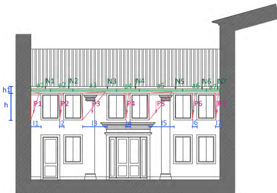
Figura 5.13 Rappresentazione del meccanismo di catena cinematica nel piano
