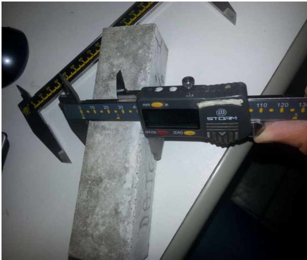
Figura 54-Misurazione di un provino di Datolite con calibro Vernier
