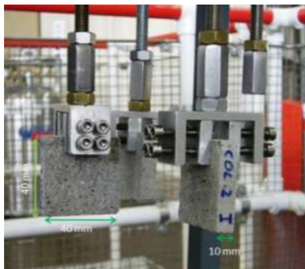
Figura 57- Sezioni dei provini di malta montati sul portacampioni per le misure di attenuazione.
