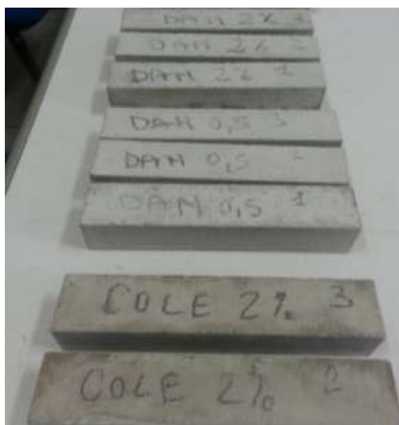
Figura 21- provini prismatici 40x40x160 mm
