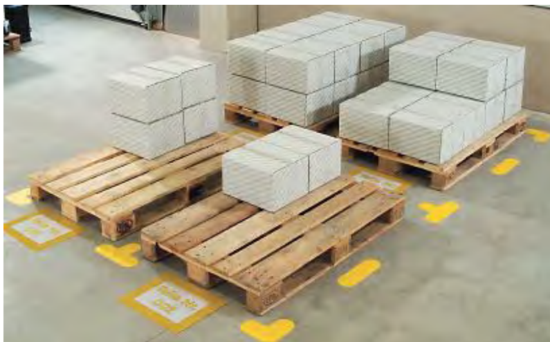
Figura 3.12 – Segnali visual per il controllo dello spazio da destinare allo stoccaggio delle merci.
