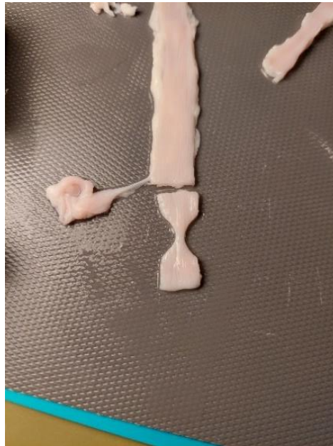
Figura 2.3: Provino a forma di osso di cane di lunghezza L_0=5 mm e di larghezza 2 mm ottenuto da uretere nativo fresco.
