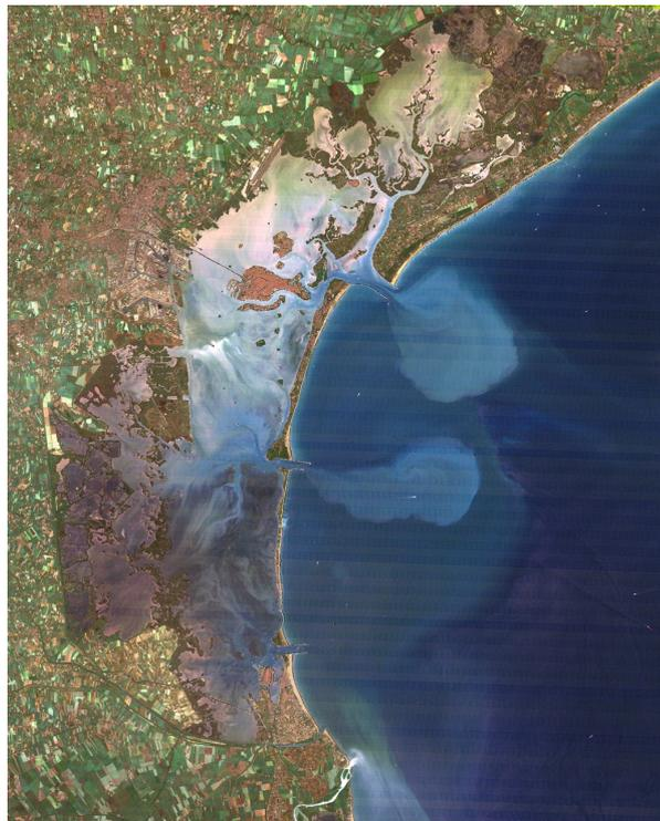
Figura 2-4 Immagine Landsat dell'agosto 1998 che evidenzia la formazione, in fase di riflusso, di due getti tramite i quali i sedimenti fini vengono espulsi in Adriatico e depositati lontano dalle testate dei moli.
