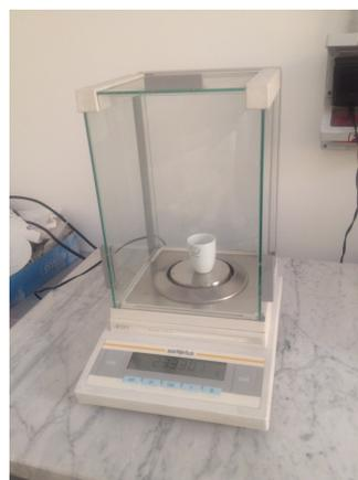
Figura 3-10 Bilancia analitica per il calcolo del peso del crogiolo e del campione al suo interno.
