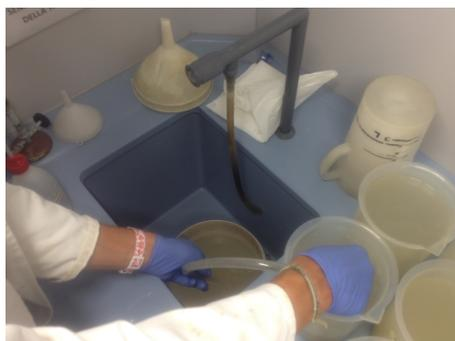
Figura 3-14 Sifonamento con tubicino di plastica flessibile. Si sfrutta il salto di potenziale tra il bancone ed il lavandino posto più in basso per svuotare il becker fino alla misura ritenuta più opportuna.
