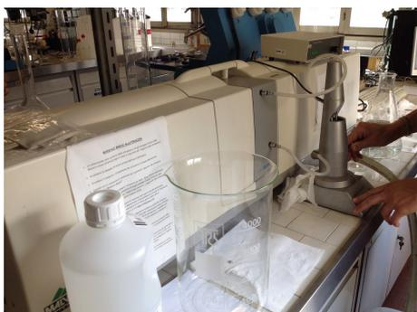
Figura 3-17 Mastersizer 2000, lo strumento usato per discriminare la granulometria dei campioni.
