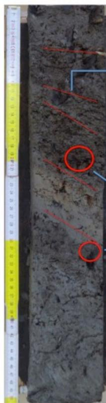
Dal basso verso l'alto si riscontra una laminazione sempre meno inclinata. Si ipotizza l'istaurarsi di un ghebo che, erodendo la superficie di una barena attecchita, crea l'inclinazione. Con l'accumulo di fango in questo canale ne consegue l'occlusione e la ripresa dell'attecchimento su una superficie che torna ad essere piana.
