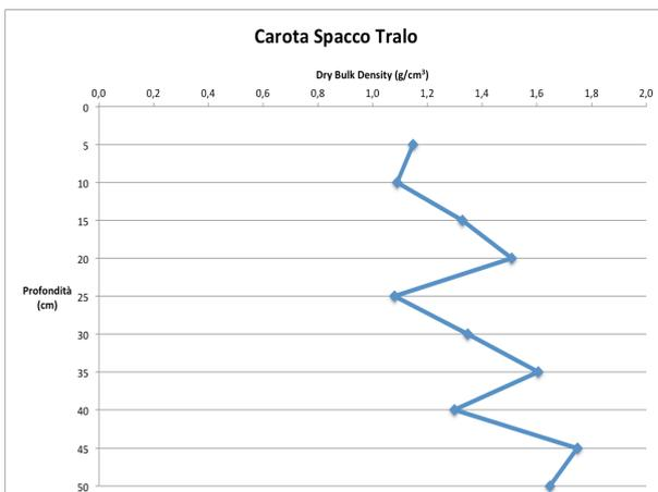
Figura 4-19 I tre grafici rappresentano, in funzione della profondità, la percentuale della perdita in peso del campione pre e post trattamento in muffola (in alto a sinistra), la variazione della granulometria del  $D_{50}$  (in alto a destra) ed i valori della densità dei campioni (a sinistra).
