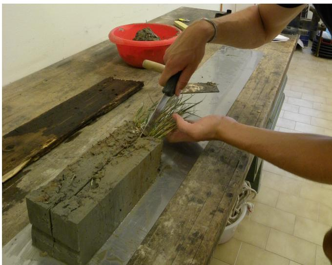
Figura 3-4 La carota viene divisa in due parti con un taglio parallelo al lato lungo. Il taglio non è sempre semplice e scontato per la possibile presenza di grossi pezzi di radici che rischiano di far disfare la forma della carota e rendere difficoltose le successive operazioni.
