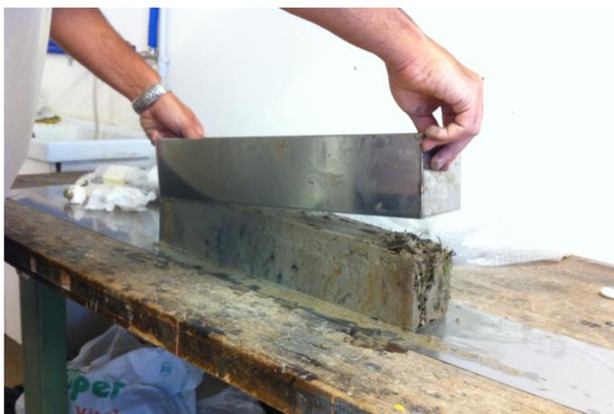
Figura 3-3 Estrazione della carota dalla cornice in laboratorio. Spesso le carote si presentano molto umide specialmente se prelevate in un momento di marea medio alta.
