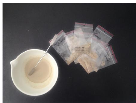
Figura 3-16 Così è come si presenta la ciotola di ceramica dopo tre giorni di forno a 50°C. L'acqua è evaporata e la patina marroncina è il campione inorganico che sarà poi raschiato con la spatolina metallica e posto nelle buste di plastica a chiusura ermetica contrassegnate con il nome del campione.
