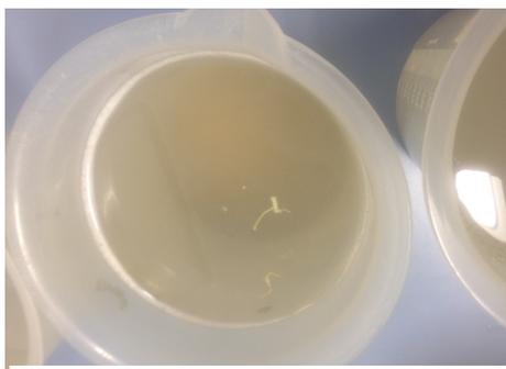
Figura 3-13 Becker con campione trattato con acqua ossigenata, diluito in acqua deionizzata. In superficie galleggia la materia organica residua non disciolta: in foto si vede bene un piccolo pezzo di radice.
