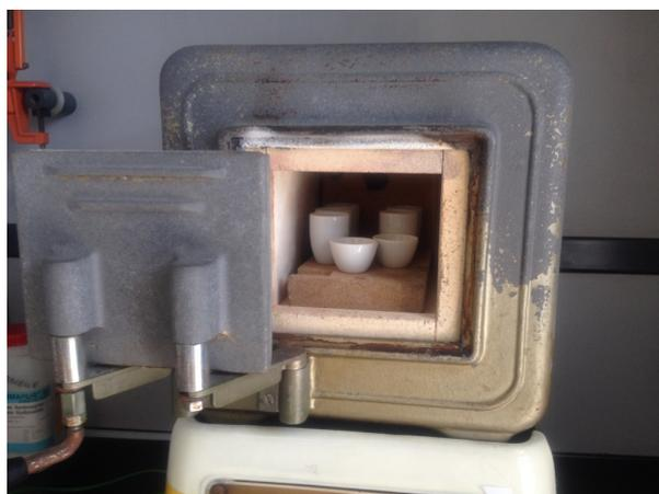
Figura 3-8 Crogioli contenenti i campioni polverizzati disposti all'interno del forno a muffola.
