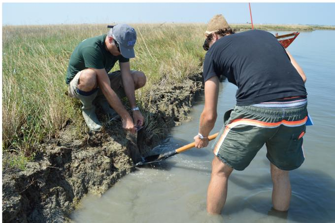
Figura 3-2 Operazione d'infissione della cornice sul margine della barena.
