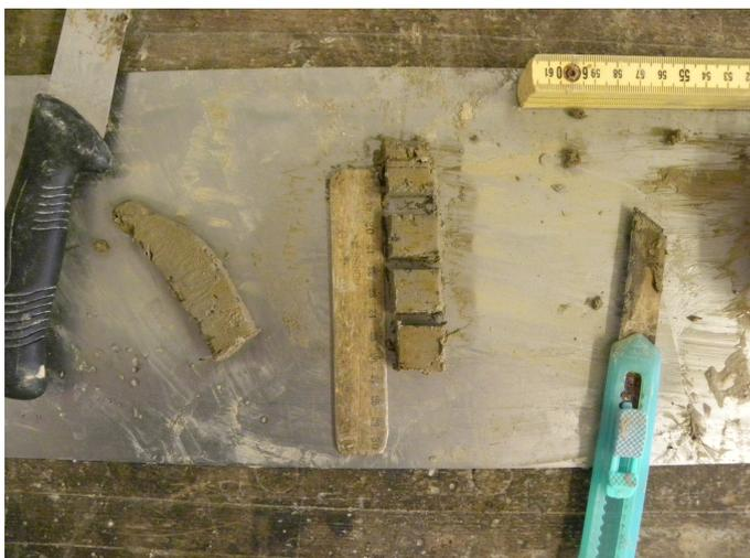
Figura 3-5 Il fine ultimo del sezionamento è ottenere quattro campioni ogni 5 cm di profondità per l'analisi del contenuto organico e l'analisi granulometrica.
