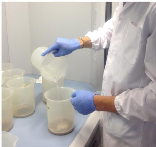
Figura 3-11 Acqua ossigenata al 35% versata nel becker contenente il campione secco.
