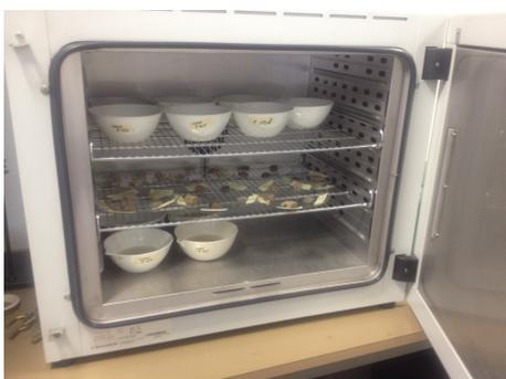
Figura 3-15 Forno che ospita, nella mensola in alto e alla base, le ciotole contenenti il residuo inorganico e l'acqua non sifonata per evitare turbolenze e perdita di sedimento fine. Nella mensola intermedia, invece, si vedono i vetri da orologio con i campioni in fase di asciugatura.
