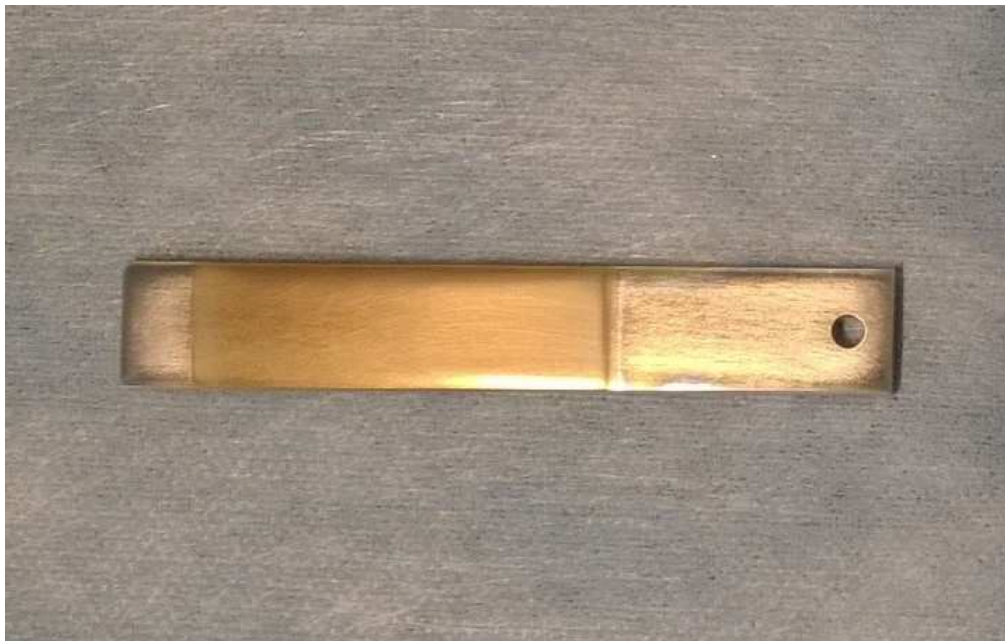
Fig. 6.7 – Substrato di alluminio su cui è stato eseguito il deposito di nitruro di alluminio su una delle sue superfici. Lo spessore nominale è pari a 2 mm.
