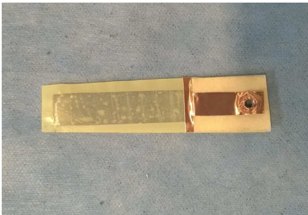
Fig. 6.13 – Applicazione del nastro di rame 3M 1181 alla barretta di alluminio. In corrispondenza del foro, sotto allo strato di nastro di rame è stata applicata una rondella M3.
