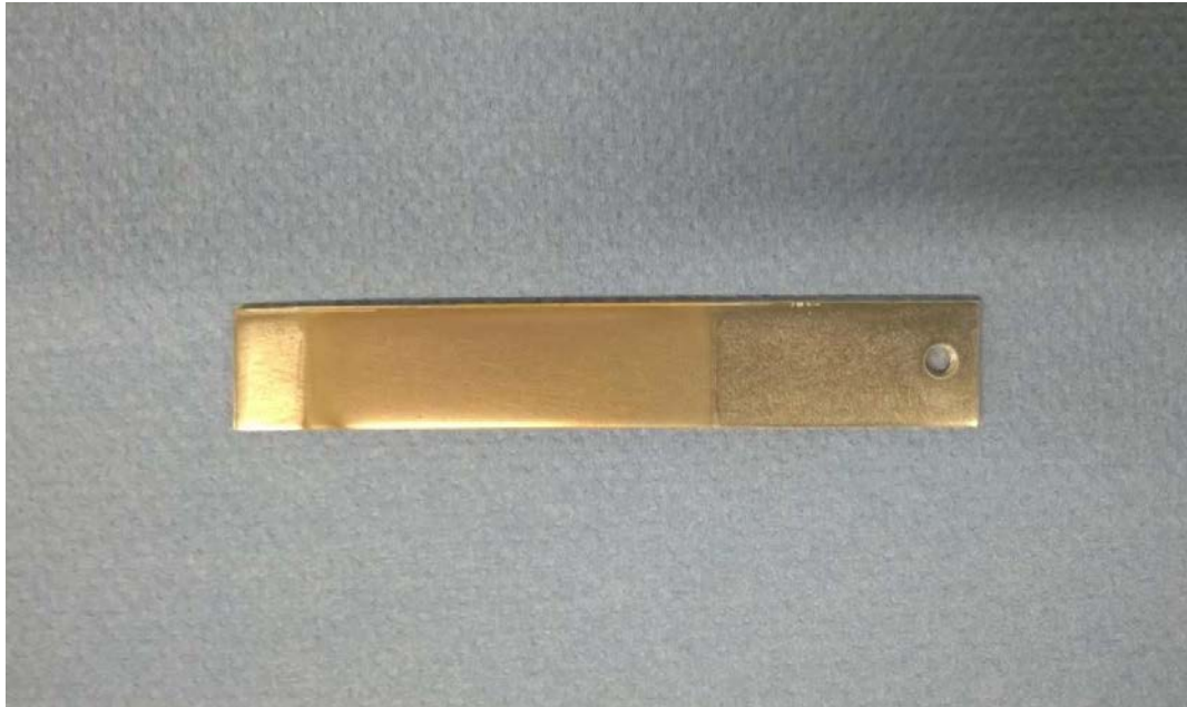
Fig. 6.32 – Substrato di alluminio su cui è stato eseguito il deposito di nitruro di alluminio su una delle sue superfici. Lo spessore nominale è pari a 2 mm.
