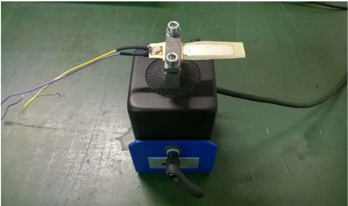
Fig. 7.4 – Shaker elettrodinamico MODAL SHOP 2007E su cui viene montato il convertitore piezoelettrico in configurazione a trave a sbalzo.
