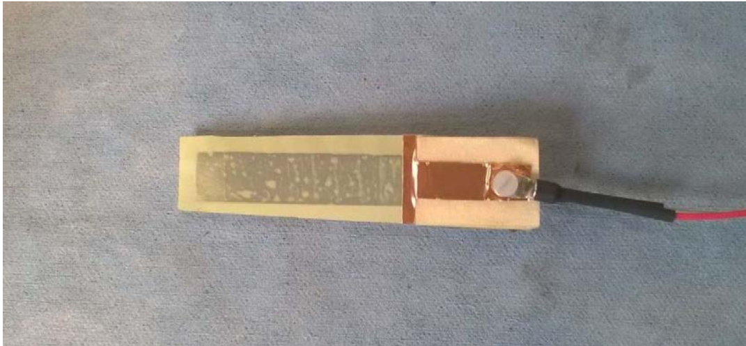
Fig. 6.14 – Collegamento di due fili mediante capocorda ad occhiello: uno sull'elettrodo superiore e uno sull'elettrodo inferiore, entrambi bloccati da una vite di plastica (M3) più corrispondente dado di plastica. Alla fine (sopra ai capicorda), vengono poste le guaine termorestringenti.
