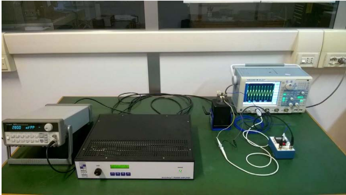
Fig. 7.1 – Configurazione utilizzata per eseguire le misure sul convertitore piezoelettrico in configurazione a trave a sbalzo. A sinistra si vede il generatore di funzioni Agilent 33120 A, al centro l'amplificatore SmartAmp POWER AMPLIFIER 2100E21-100, mentre sulla destra si vede lo shaker elettrodinamico MODAL SHOP 2007E (su cui è montato il convertitore piezoelettrico), alla cui estremità superiore è collegato l'accelerometro piezoelettrico PCB 352C65 che poi si collega al condizionatore di segnale PCB 480C02, il quale poi è collegato al canale 2 (CH2) dell'oscilloscopio YOKOGAWA DL9140 710310. Ai morsetti elettrici della trave a sbalzo viene collegata una sonda passiva di tensione YOKOGAWA 700998, poi collegata al canale 1 (CH1) dell'oscilloscopio YOKOGAWA DL9140 710310.
