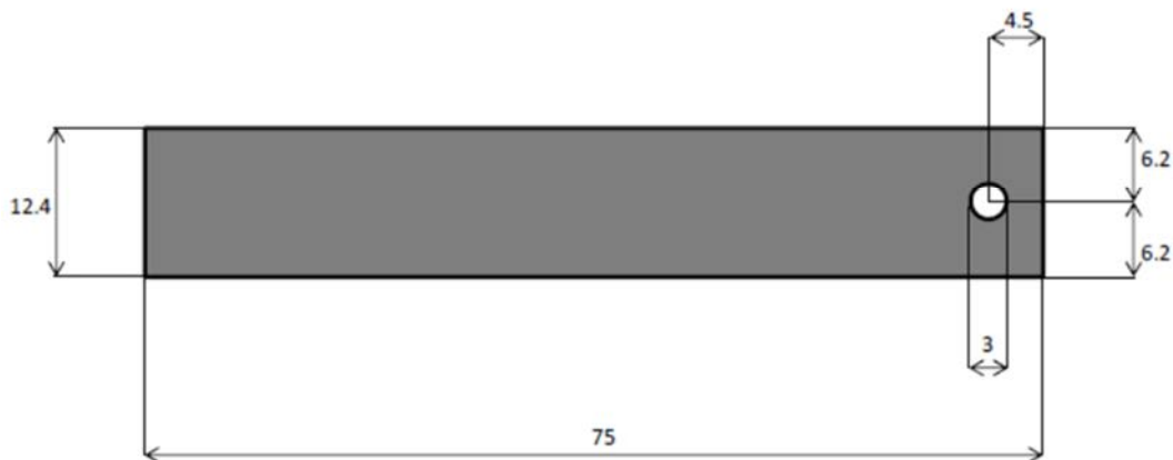
Fig. 6.1 – Substrato di alluminio. Lo spessore nominale è pari a 2 \text{ mm} .
