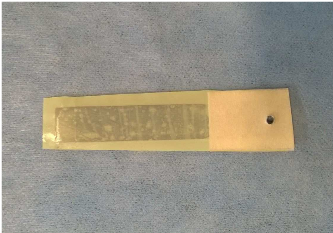
Fig. 6.11 - Applicazione di cinque strati di carta sulla barretta di alluminio a partire da 51\text{ mm} dalla punta fino alla fine della struttura. Lo spessore di uno strato di carta è circa pari a 0.1\text{ mm} .
