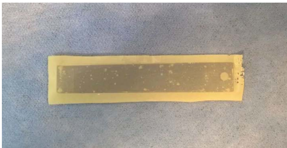
Fig. 6.34 – Superficie della barretta di alluminio, lato deposito, coperta da uno strato di nastro in poliestere 3M 74.
