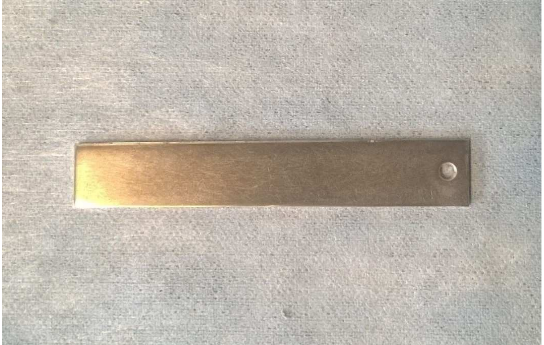
Fig. 6.24 – barretta di alluminio 75 \times 12.4 \text{ mm}^2 con foro del diametro di 3 \text{ mm} ad una distanza di 4.5 \text{ mm} dall'estremità. Lo spessore nominale è pari a 2 \text{ mm} .
