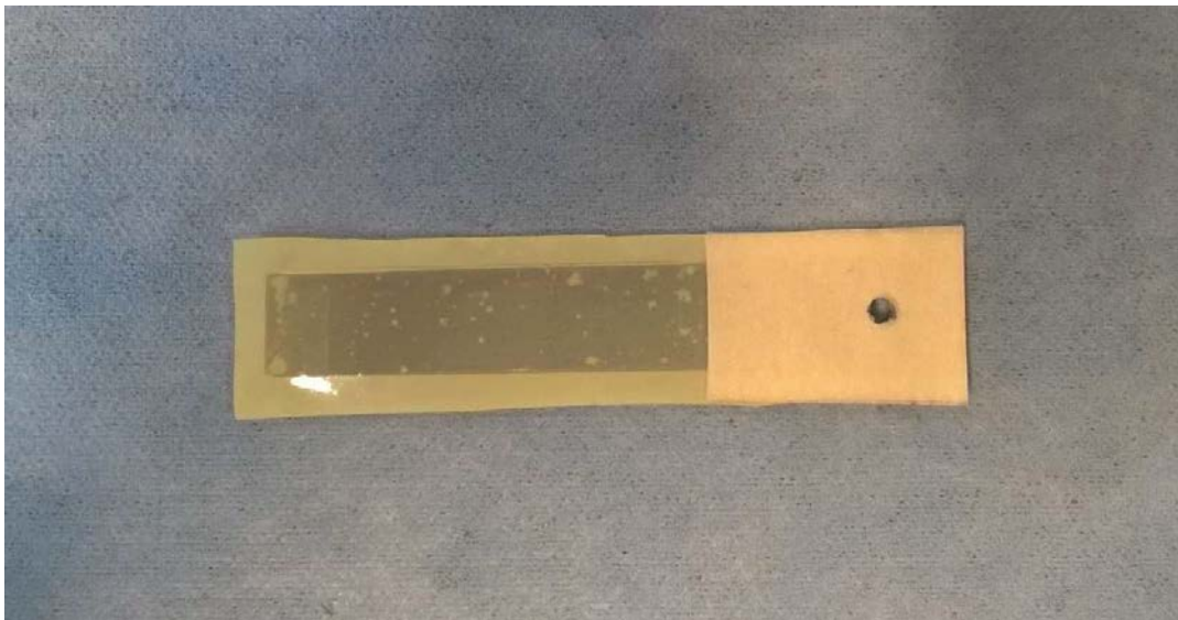
Fig. 6.36 - Applicazione di cinque strati di carta sulla barretta di alluminio a partire da 51\text{ mm} dalla punta fino alla fine della struttura. Lo spessore di uno strato di carta è circa pari a 0.1\text{ mm} .
