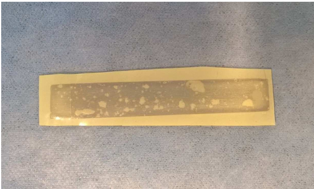
Fig. 6.9 – Superficie della barretta di alluminio, lato deposito, coperta da uno strato di nastro in poliestere 3M 74.
