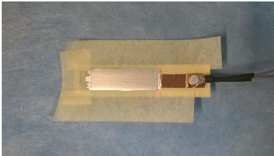
Fig. 6.42 – Applicazione della vernice conduttiva in argento RS Silver Conductive Paint 123-9911 (SCP) alla barretta di alluminio.
