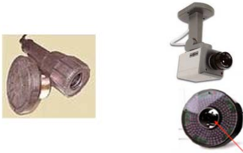
Figura 3.4: Sensore acustico (a sinistra) e sistema optoelettronico (a destra), [44].
