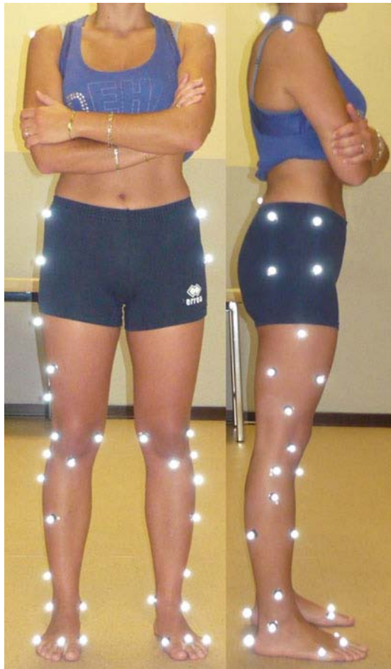
Figura 3.8: Marker set per il protocollo FullBody, [61]
