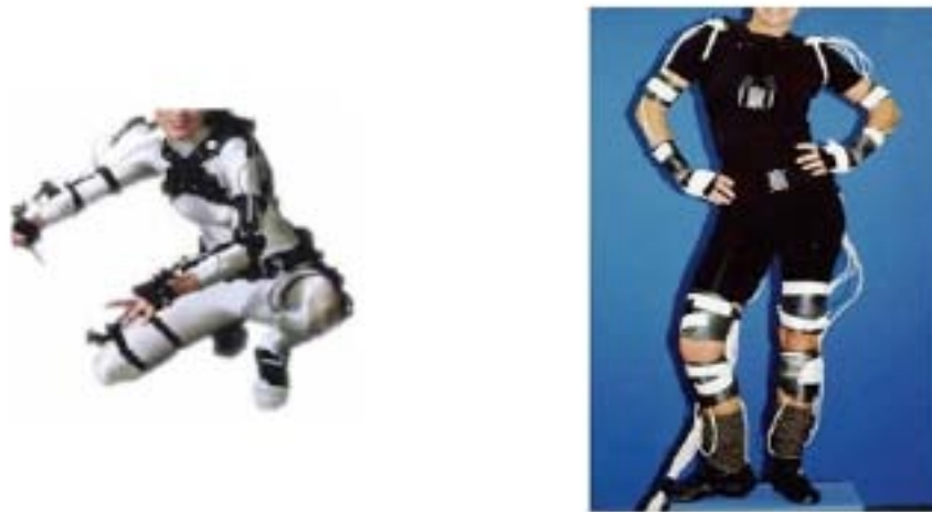
Figura 3.3: Sistema elettrogoniometrico (a sinistra) e sistema elettromagnetico (a destra), [44].
