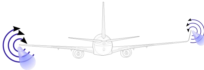
Figura 5.3.2 Effetto dell'ala di estremità sulla resistenza indotta.
