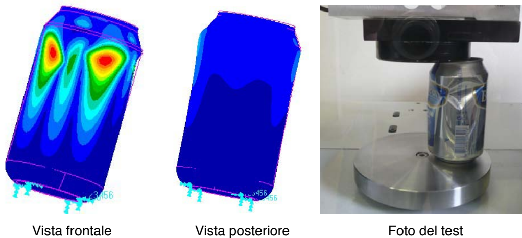
Fig. 4.38: Deformate risultanti dalle analisi non lineari e dai test per la condizione di carico con eccentricità e = 17.5 [mm]
