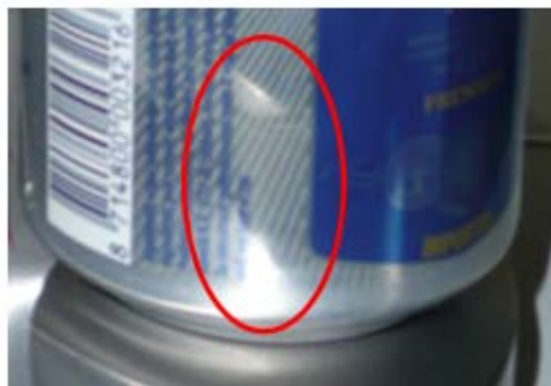
Fig. 4.28: Provino con difetto superficiale visibile
