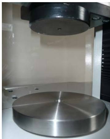
Fig. 4.22: Supporto maggiorato in acciaio
