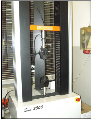
Figura 3.14: Dinamometro Galdabini Sun 2500 (a) ed esempio di estensimetro (b)
