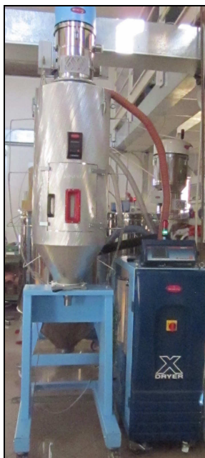
Figura 3.6: Deumidificatore X Dryer 21 collegato alla tramoggia OTX 100
