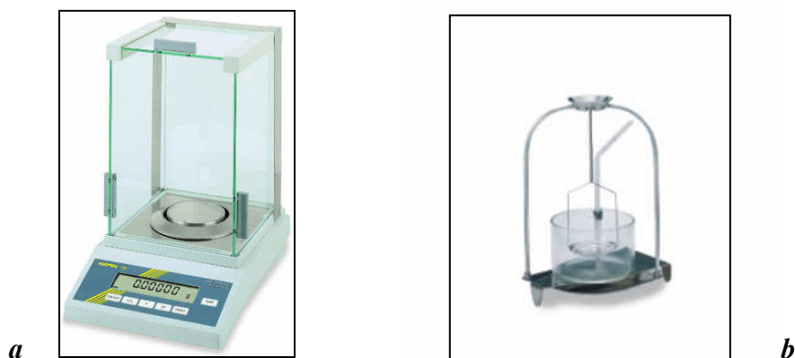
Figura 3.11: Bilancia di precisione KERN 770 (a) e kit per le misure di densità(b)
