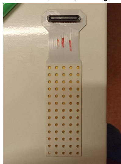
Figura 2.6. Matrice di 64 elettrodi utilizzata per l'HDsEMG.
