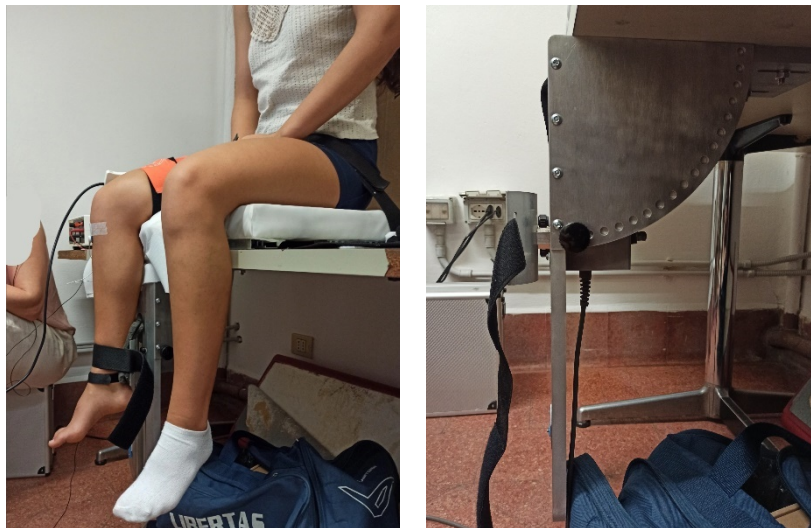
Figure 2.2 e 2.3. In foto un partecipante pronto per l'esecuzione dei test HDsEMG (Figura 2.2) e il dinamometro utilizzato nei test sperimentali (Figura 2.3).
