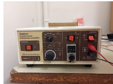
Figure 2.7 e 2.8. Matrice centrata al punto motore e posizionata in parallelo all'orientamento delle fibre del muscolo vasto laterale (Figura 2.7) e Digitimer DS7A utilizzato per somministrare le stimolazioni elettriche percutanee (Figura 2.8).
