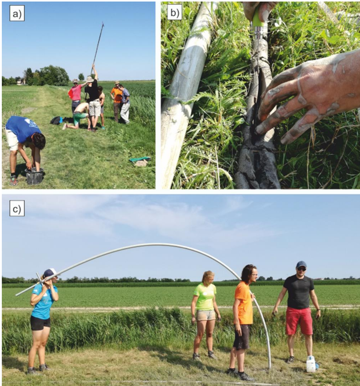
Figura 4.1: carotaggi manuali svolti dagli studenti durante il campo di rilevamento presso Caorle (VE), in particolare: a) carotaggio manuale con aste metalliche (adatte a suoli mediamente coesivi); b) fase di apertura della carota estratta; c) carotaggio manuale con aste plastiche (adatte a suoli sabbiosi).
