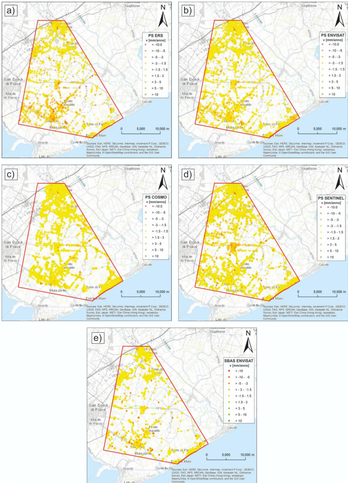
Figura 4.4: panoramica dei dati interferometrici utilizzati durante questo studio, in particolare: a) dati PS-ERS, b) dati PS-ENVISAT, c) dati PS-COSMO-Skymed, d) dati PS-SENTINEL, e) dati SBAS-ENVISAT.
