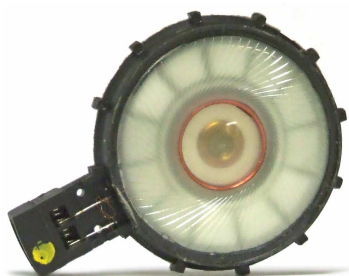
Figura 2.1 Trasduttore dinamico ( sinistra ) , modello di funzionamento di un trasduttore elettrostatico ( destra )
