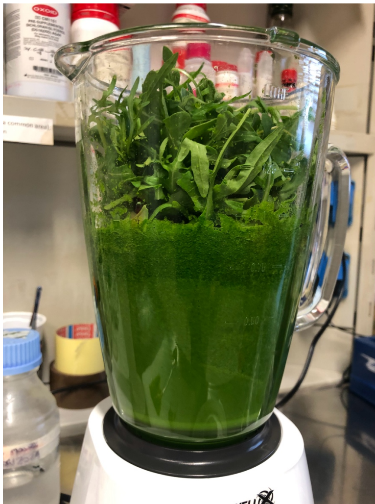
Figura 7 – Processo di triturazione della rucola all'interno del frullatore Moulinex Blendforce Glass.
