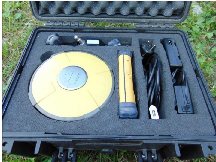
Figura 4.13: ricevitore GPS Topcon Hiper2 Rover (Rocco, 2017).
