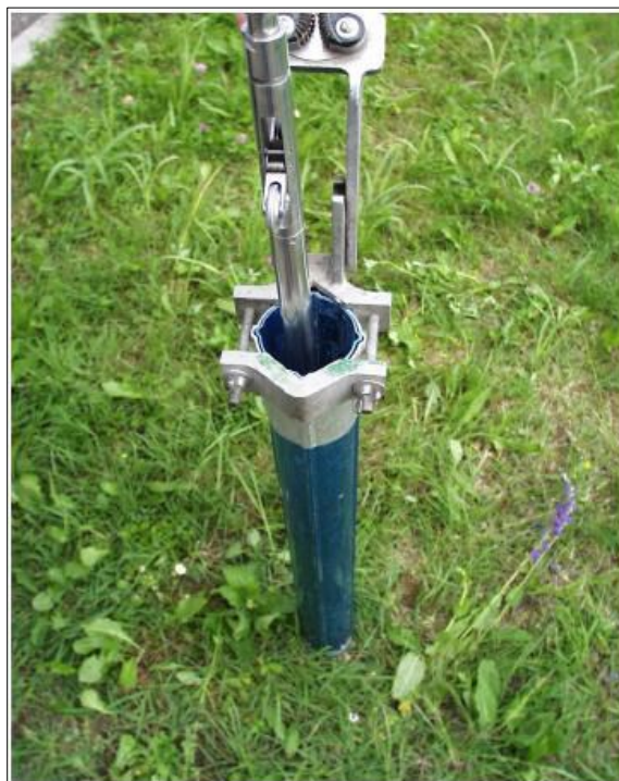
Figura 1.14: inclinometro in opera (Fanti, 2015).
