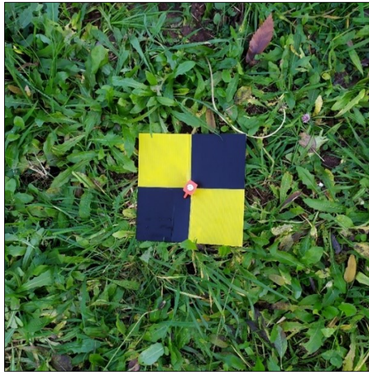
Figura 4.11: target di riferimento utilizzato in fase di rilievo.
