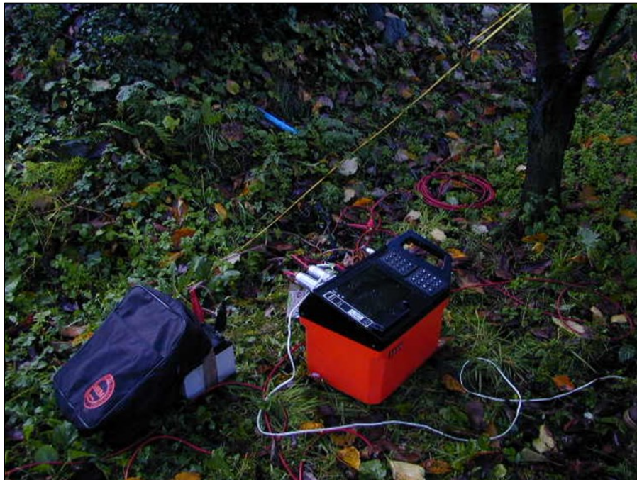
Figura 2.9: esecuzione dell'analisi audiomagnetotellurica (Archivi dei Servizi Forestali Regionali del Veneto).
