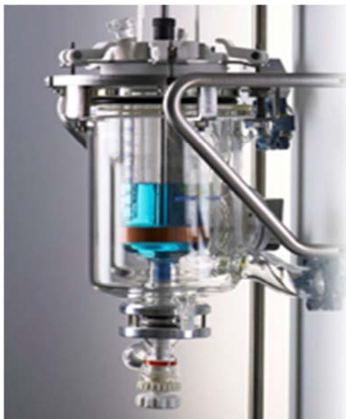
Figura 4.9. Reattore in vetro per RC1 incamiciato esternamente, volume 2 litri.
