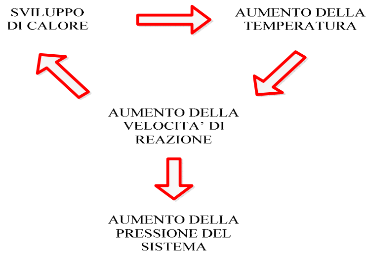
Figura 1.2. Meccanismo delle reazioni runaway.
