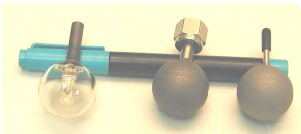
Figura 4.7. Celle portacampione in vetro e in acciaio, con attacchi da 1/4" e 1/8".
