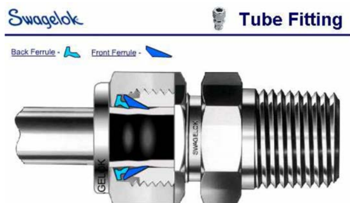
Figura 4.6. Schema di funzionamento dei giunti Swagelok..
