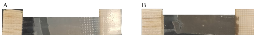
Figura 4.7 A) Rottura di una membrana in OxPVA. B) Rottura di una membrana in OxPVA+CNT allo 0.1%.
