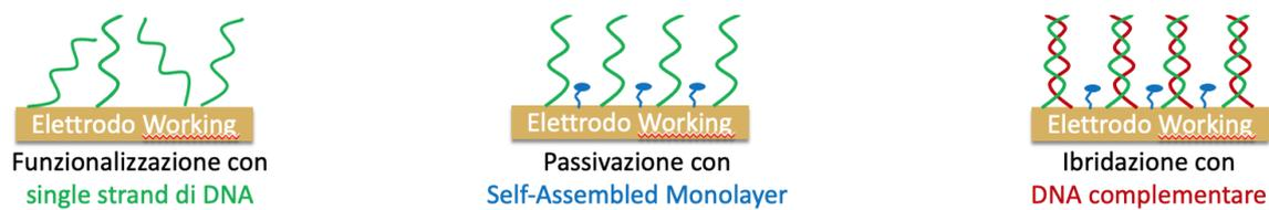
Figura 16. Schema generale del funzionamento di un genosensore. Si introduce come passaggio intermedio la passivazione della superficie con SAM per regolarizzare la disposizione delle catene singole di DNA e facilitare l'ibridazione.
