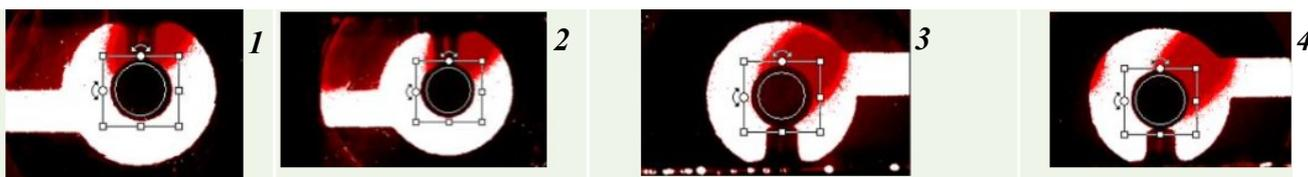
Figura 42. Scansioni in fluorescenza di sensori funzionalizzati a seguito dell'incubazione. I numeri 1 e 2 presentano ibridazione con cDNA, i numeri 3 e 4 sono stati incubati con il solo buffer.
