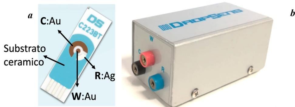
Figura 23. Sensore DRPC223BT (a) e relativo connettore (b)
