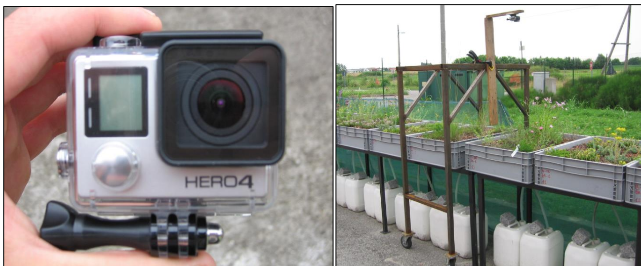
Fig. 5.28 e 5.29 GoPro Hero4 utilizzata per fotografare gli accrescimenti delle piante (Fig. 5.28) e carrello su cui è stata fissata la GoPro per eseguire le foto dall'alto (Fig. 5.29)
