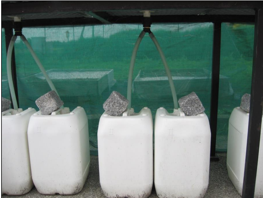
Fig. 5.26 Taniche in cui si accumula il deflusso di acqua a seguito di un evento piovoso
