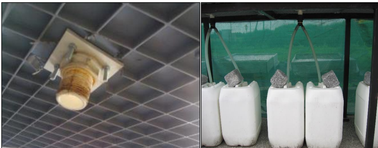
Fig. 5.19 e 5.20 Dettaglio del foro di scarico (5.19) e taniche con raccordi a “V” in cui viene convogliata l’acqua di deflusso (5.20)
