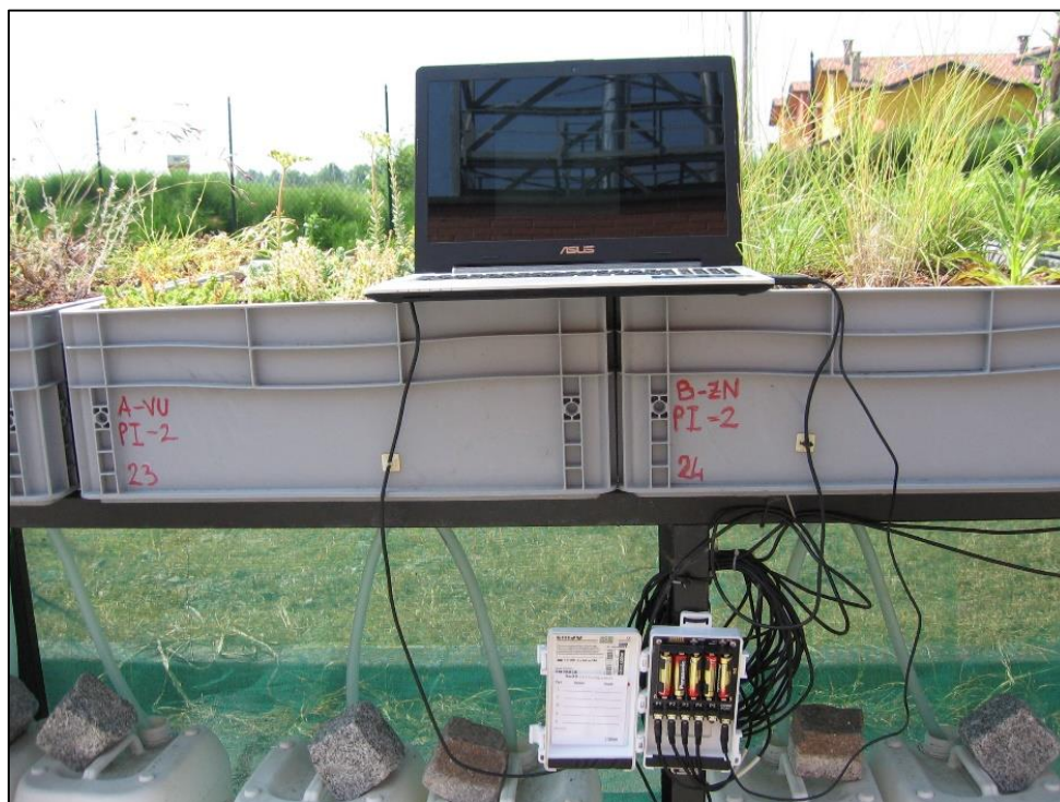
Fig. 5.27 Computer collegato al data logger per scaricare i dati di temperatura raccolti
