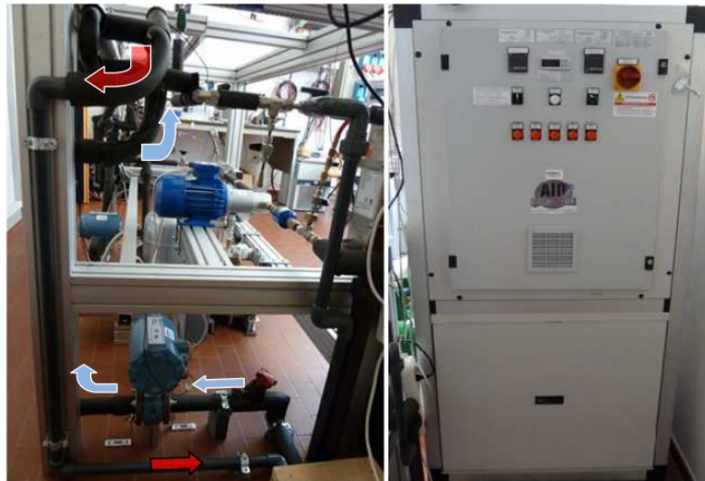
Fig. 2.7 Circuito dell'acqua fredda del precondensatore [4].
