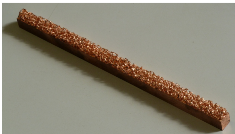
Fig. 2.11 Provino di rame utilizzato nella prova [foto scattata in laboratorio].
