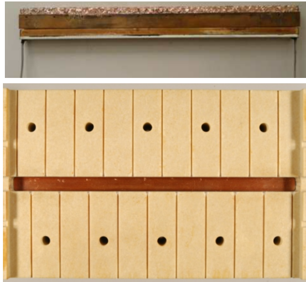
Fig. 2.12 Schiuma appoggiata al riscaldatore (in alto); la stessa base, priva della schiuma, alloggiata nella sezione [foto scattate in laboratorio].
