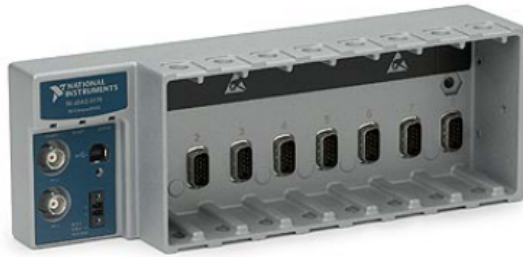
Fig. 2.17 NI cDAQ-9178: chassis del sistema di acquisizione. Si notano le slot per i moduli, l'ingresso per l'alimentazione e la porta di comunicazione USB a cui verrà collegato il computer [23].
