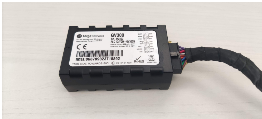
Figura 3.2: Dispositivo e relativo collegamento al CAN-bus
