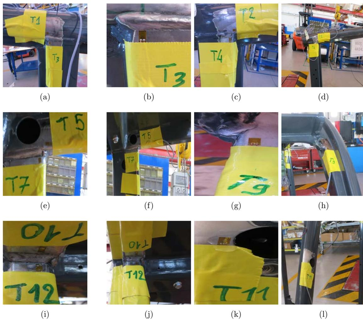
Figura 7.12: Posizione Estensimetri OHG 3
