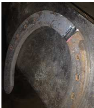
Fig.12 Taglio e dimezzamento spessore utilizzando il flessibile.
