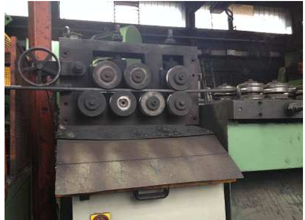
Fig.15 Treno di rulli raddrizzatori.
