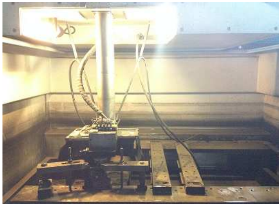
Fig.18 Macchina per elettroerosione (non in funzione).
