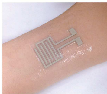
Figura 17. Integrazione dei sensori di idratazione sopra presentati in un bracciale per realizzare un dispositivo indossabile [21] .
