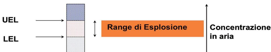
Figura 2: Range di esplosione
