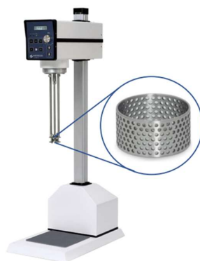
Figura 2.1: Turboemulsore Silverson-L5T con ingrandimento del setaccio emulsionante
