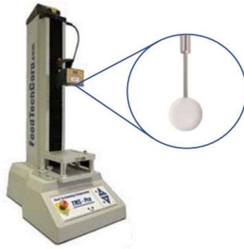
Figura 2.5: Texture Analyzer TMS-PRO con ingrandimento sonda in nylon
