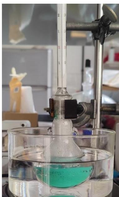
Figura 7.1. Set up recupero rame da malachite.
