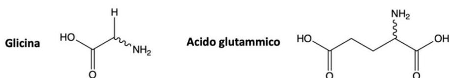
Figura 3.5. Rappresentazione delle strutture di alcuni amminoacidi studiati per la lisciviazione del rame.
