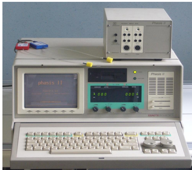
Fig 5.2.3 Apparecchiatura elettrodiagnostica: computer e amplificatore.
