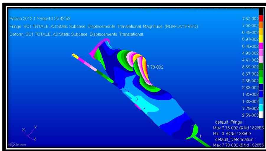
Figura 60: displacement, diminuito leggermente lo spostamento massimo
