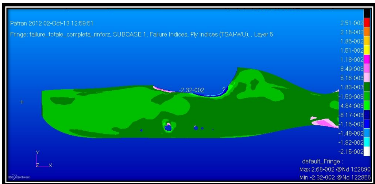
Figura 72: indici di failure core, fusoliera con rinforzi
