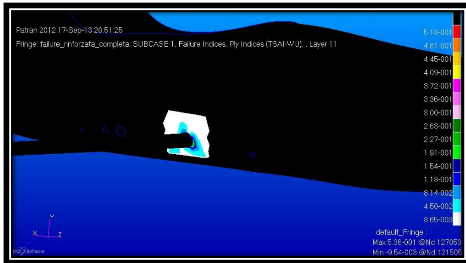
Figura 62: indice di failure nello strato di rinforzo
