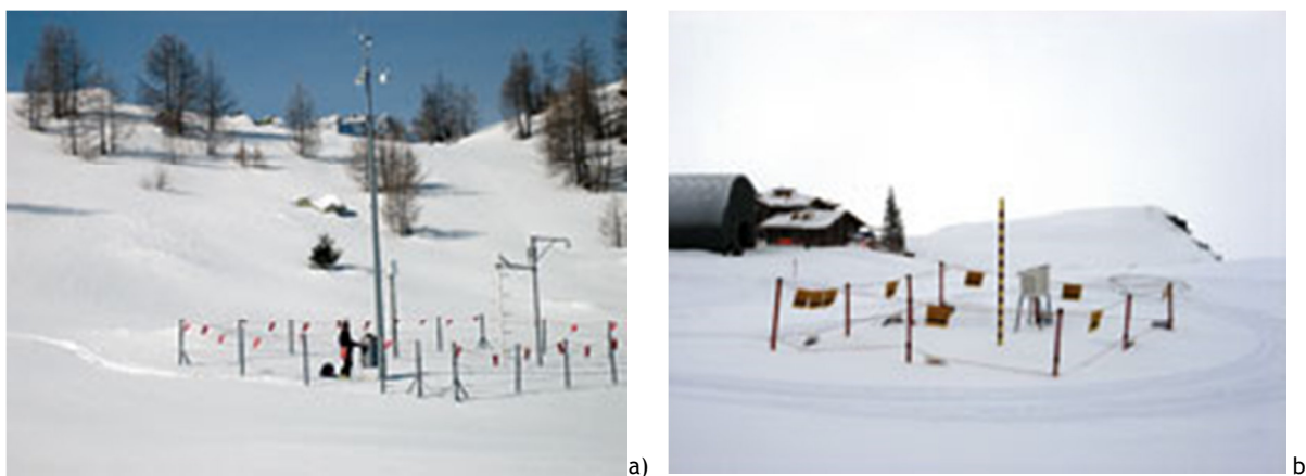
Figura 4.15 Stazioni nivometeorologiche: automatica e tradizionale (Fonte: http://www.aineva.it )
