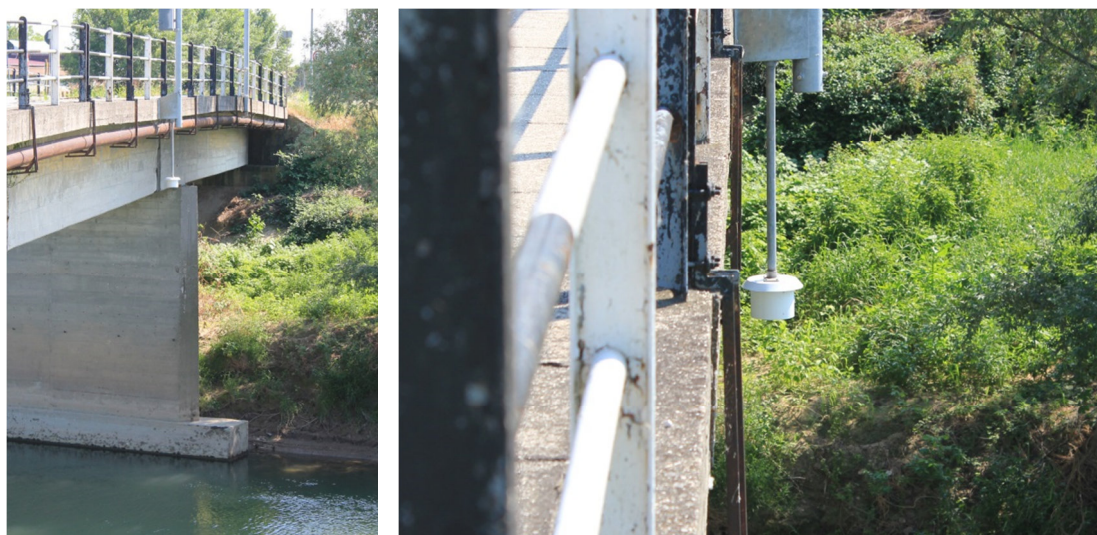
Figura 4.10 Idrometro a ultrasuoni per la misura dei livelli idrometrici
