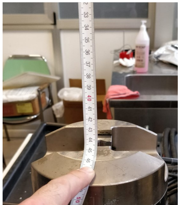
Figura 2.13: Distanza massima tra le ganasce in sicurezza della MTS Mini Bionix 858.
