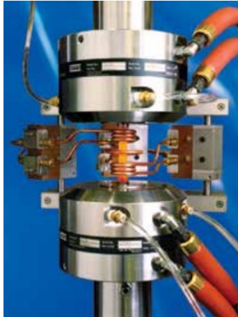
Figura 2.8: Sistema di riscaldamento per induzione [7].
