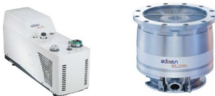
Figura 1.17: A sinistra una pompa rotativa di tipo Scroll (pressioni fino a 10^{-2} \div 10^{-3} mbar) e a destra una turbo-molecolare (si raggiungono pressioni fino a 10^{-5} \div 10^{-6} mbar).
