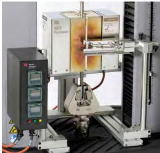
Figura 2.9: Model 653 Furnaces per Sistema Serie 40(EM) [7].
