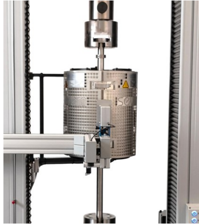
Figura 2.7: Forno tubolare apribile [6].
