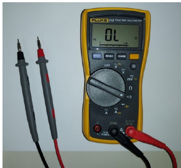
Figura 4.14: Multimetro utilizzato per il confronto della tensione rilevata tra ingresso e uscita e la corrente rilevata dall'alimentatore.
