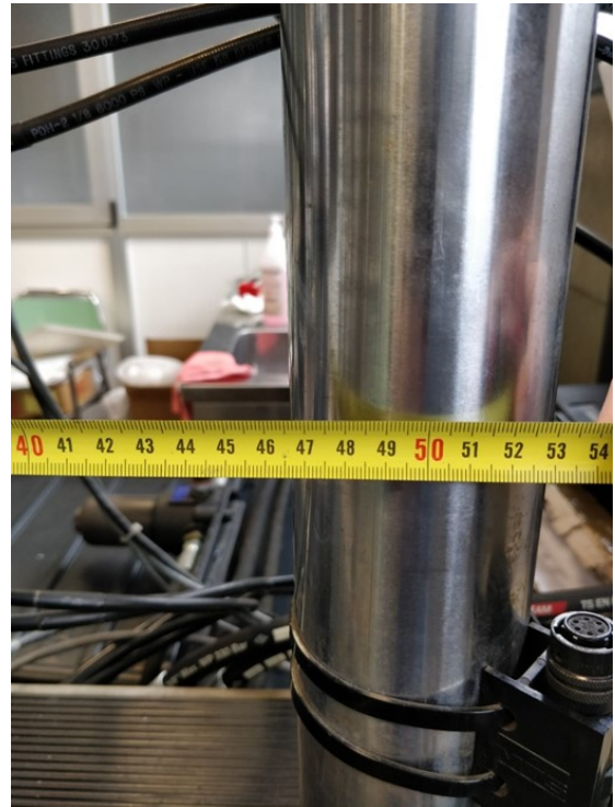
Figura 2.12: Distanza tra l'interno delle colonne della MTS Mini Bionix 858.
