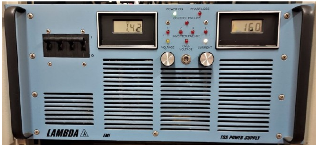
Figura 4.13: Alimentatore utilizzato in modalità di controllo di corrente durante i test ai LNL.
