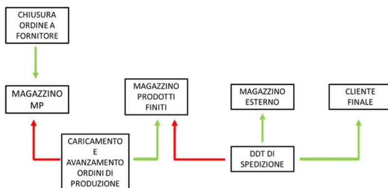
Figura 7.11: Rappresentazione schematica delle fasi della procedura di carico e scarico dei magazzini e di avanzamento degli ordini di produzione all'interno del gestionale. Le frecce in verde indicano il carico del magazzino, quelle rosse lo scarico associati alle operazioni indicate.
