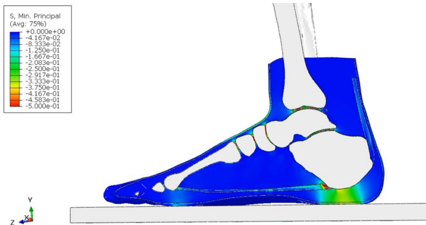
Figura 4.24 – Distribuzione delle tensioni principali minime nel modello elastico lineare
