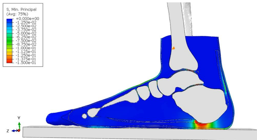
Figura 4.27 – Distribuzione delle tensioni principali minime nel modello iperelastico con \mu = 0.0035 MPa
