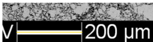
Figura 43. Particolare della scala di un'immagine SEM 50x. ImageJ è dotato di un righello digitale che permette di stabilire quanti pixel è lungo un segmento. A questo punto basta impostare nel programma la scala corretta. Es. se la riga gialla è lunga 108 pixel, sappiamo che corrispondono a 200 micron. Quindi la scala sarà di 0,54 \mu\text{m}/\text{pixel} .
