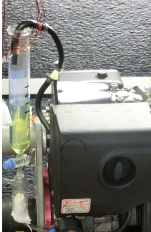
Figura 3.16: Misurazioni del consumo di gasolio
