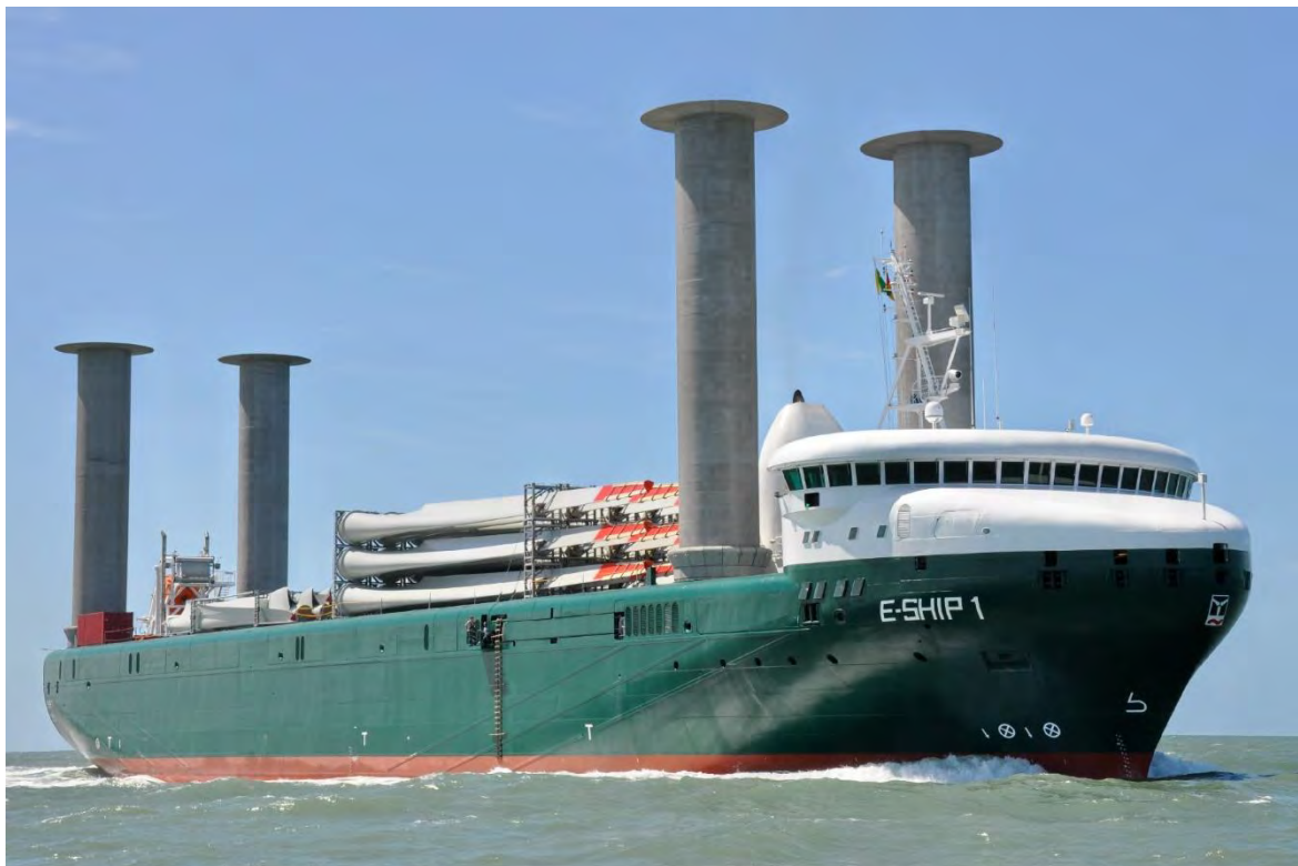
Fig. 3.20 - E-Ship , nave dotata di rotori Flettner come ausilio alla propulsione.
