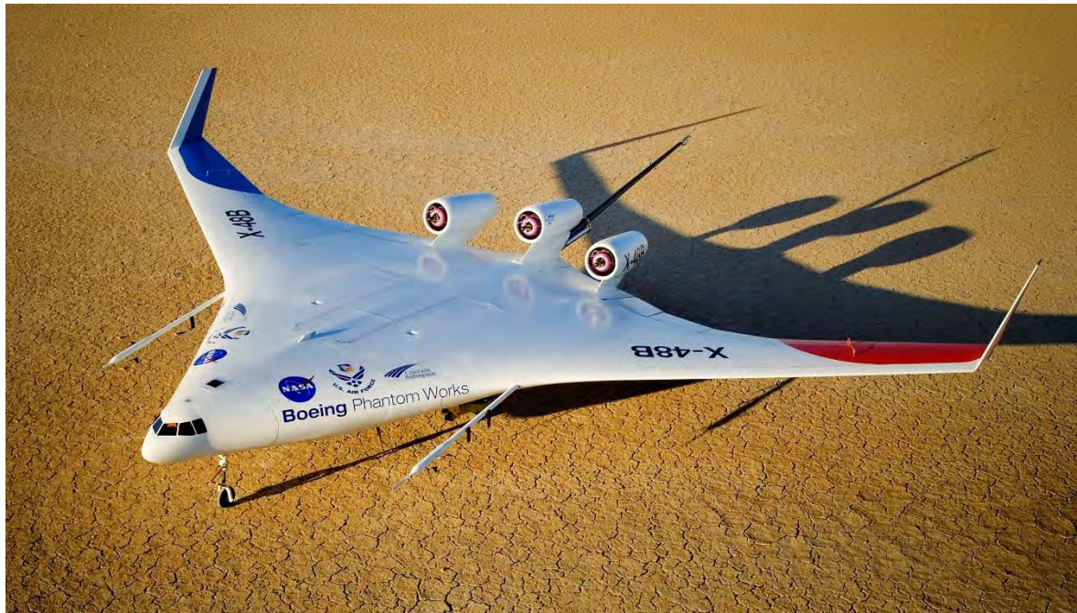
Fig. 3.17 - Modello di aereo Blended Wing Body frutto della cooperazione Boeing-NASA.
