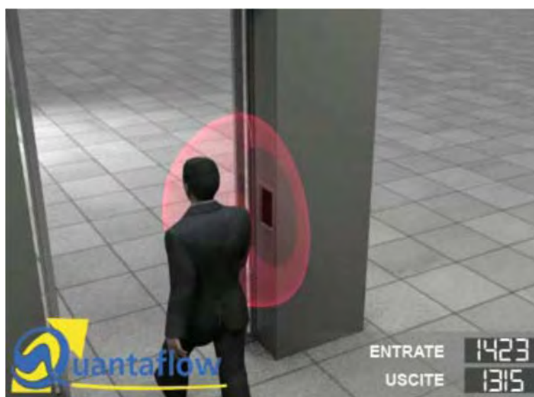
Figura 18 – Contapersone con Proxi Sensor IR (Fonte: [30])
