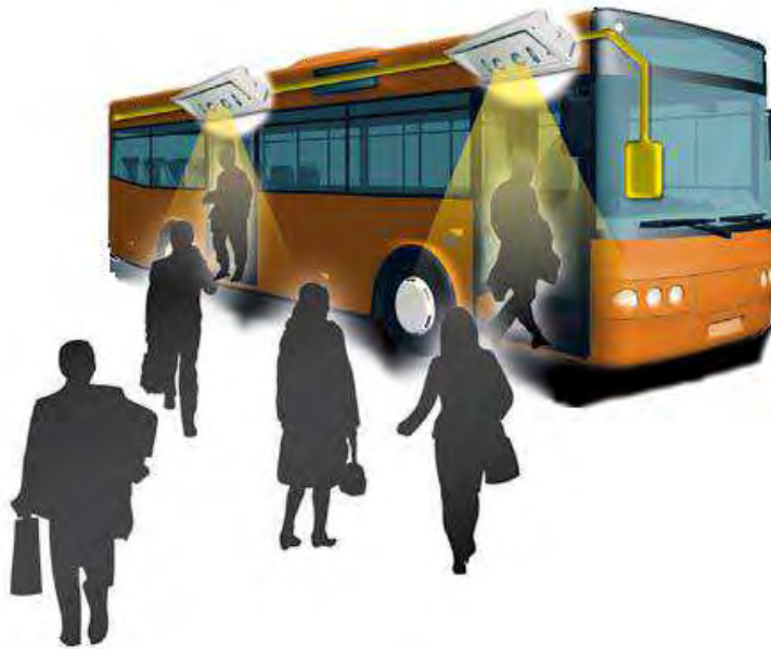
Figura 19 – Posizionamento dei contapersone a visione stereoscopica (Fonte: [31])
