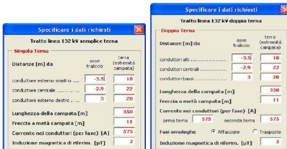
Figura 8.3 – Parametri geometrici ed elettrotecnici da inserire per caratterizzare una linea da 132 kV (la finestra di sinistra si riferisce ad una terna semplice, quella di destra ad una terna doppia)
