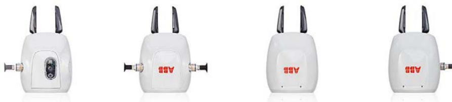
Figura 14 - Dettaglio della pinza ABB e varie combinazioni di grippers realizzate da ABB per l'IRB14000
