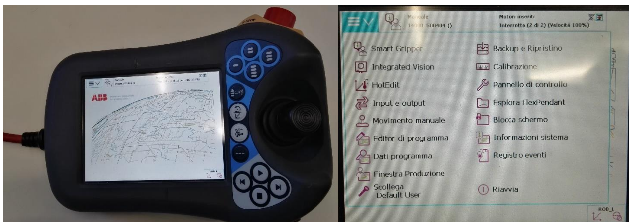
Figura 19 - Flex pendant con sistema RobotWare
